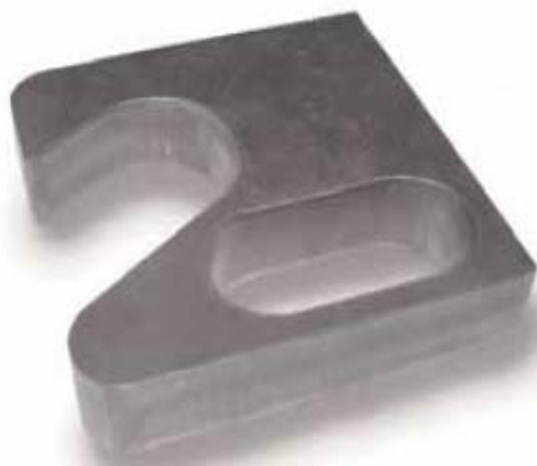
20毫米低碳钢切割样件
